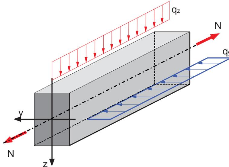
Berechnung der Normalspannungen durch Addition der einzelnen Spannungsanteile:
