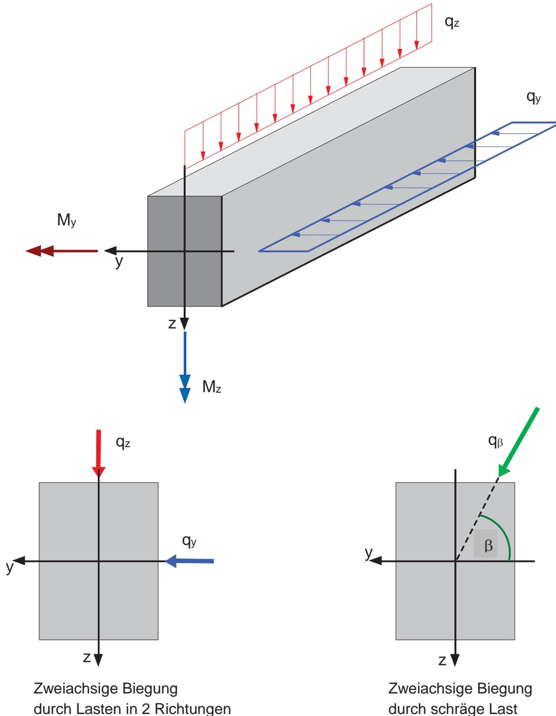
Für die Ermittlung der Spannungen ermittelt man die aus den Lasten  $q_z$  und  $q_y$  resultierenden Biegemomente  $M_y$  und  $M_z$  und errechnet getrennt, wie für die einachsige Biegung, die zugehörigen Spannung  $\sigma$ . Sämtliche Biegespannungen wirken in die  $x$ -Richtung („Normalspannungen“).
