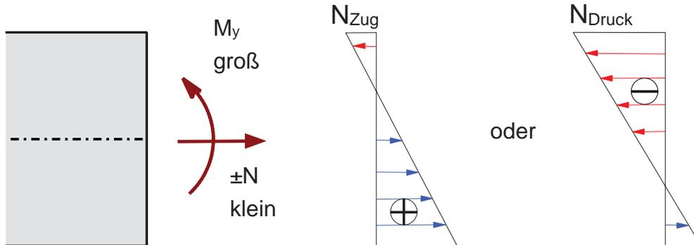
Überwiegend Normalkraft: Es treten nur Zugspannungen ( $N > 0$ )
