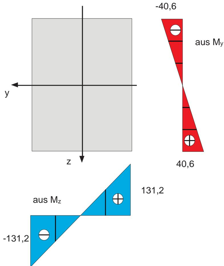
Überlagerung der Spannungen an den ausgewählten Punkten:
